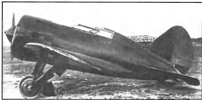
Третий опытный истребитель И-16 с мотором Райт «Циклон» мощностью 710 л.с.
