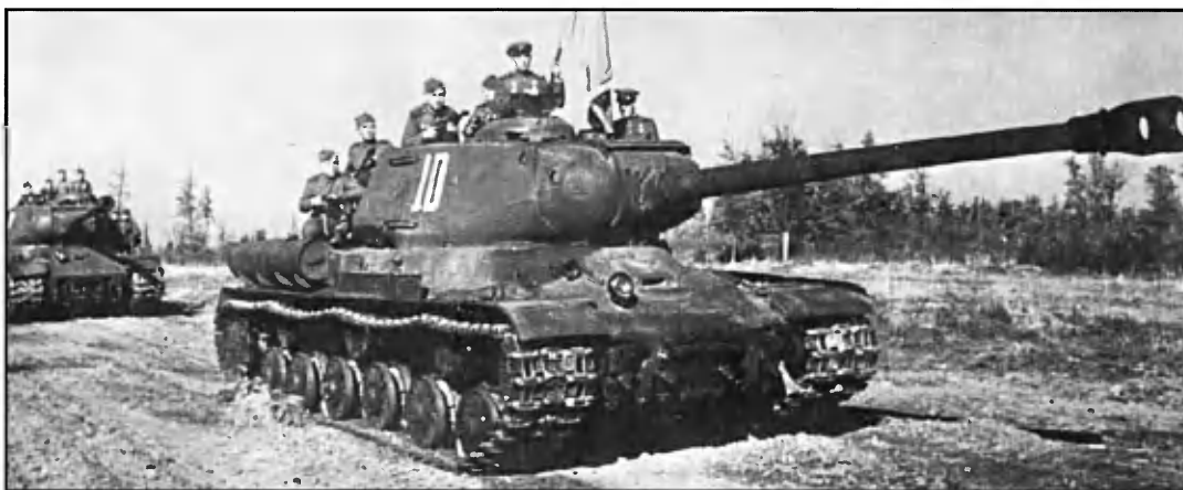
Советский тяжелый танк ИС-2, вооруженный 122-мм пушкой
