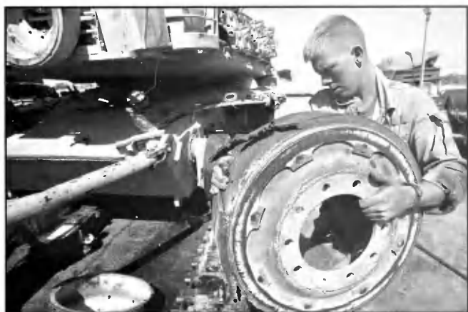
Из-за малого размера катков у «Абрамса» «обрезинка» быстро изнашивается и требует частой замены
