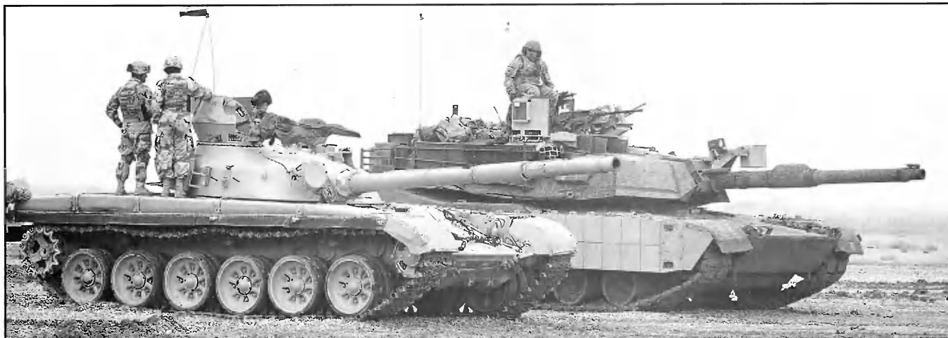
Российский танк Т-72 и американский М1 «Абрамс». Хорошо видна разница в размерах катков
