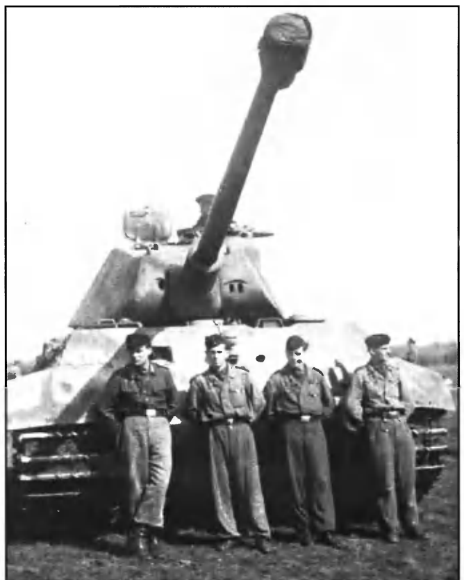
Один из первых серийных «Тигров II» с башней Порше, поставленный в войска
