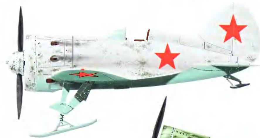
Истребитель И-16 тип 28 с 20-мм пушками в крыле, 1939 - 1940 гг.
