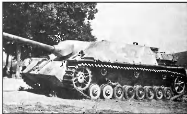
Передние два катка немецкого «танка-истребителя» на базе Pz.IV не имеют «обрезинки»
