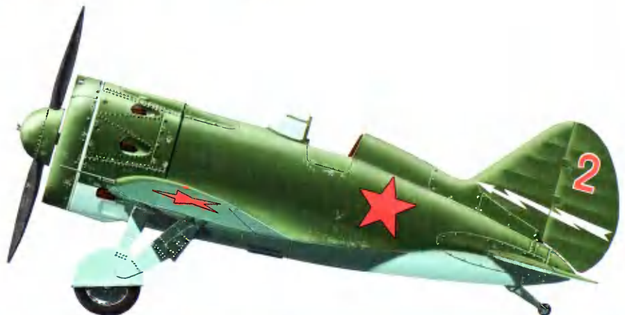
Истребитель И-16 тип 28 с 20-мм пушками в крыле, 1939 - 1940 гг.
